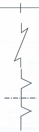
Desconcentración: Líneas quebradas en forma de dos triángulos laterales, atravesadas por líneas largas de trazo discontinuo con puntos intermedios.
