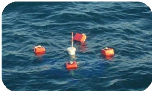
Hay que destacar que como parte del estudio de la recuperación de las profundidades de los atracaderos se utilizó además un aparato construido por el personal de ingenieros del Puerto de Acajutla, el cual proporciona a través de un sistema GPS la dirección de las corrientes marinas, la velocidad y el tiempo.
