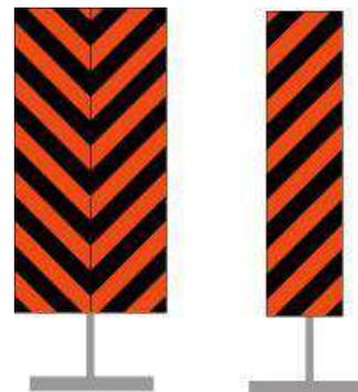
de 16", colocado en posición vertical, con franjas alternadas en colores naranja reflejante las cuales deberán tener una reflectividad mínima **Tipo IV (ASTM D 4956 – 09)** y con tinta serigráfica color negro mate, de 10cms. de ancho, inclinadas a 45° descendiendo a la derecha del tránsito, y la inclinación bajando hacia la izquierda cuando se ubiquen a la izquierda del tránsito.
