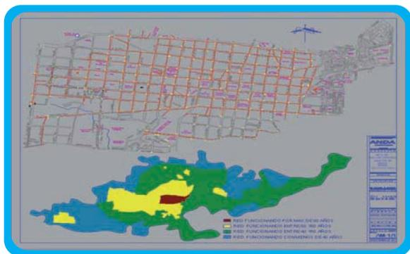
**TUBERÍAS DE AGUAS NEGRAS.** La Etapa I consiste en sustituir tuberías de 80, 60 y mas años de edad, con diámetros de 10, 12 y 15", las cuales se sustituirán en aproximadamente 152.6 km.
