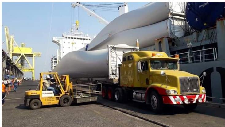
Foto 1. Descarga de los principales componentes para el parque eólico Ventus.
