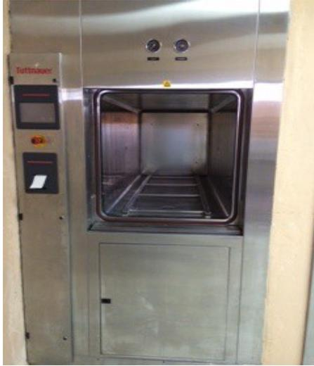
Equipamiento de un Esterilizador a Vapor autoclave Industrial
