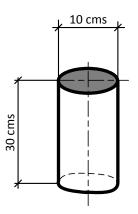
Cada mojón de concreto tiene 10 centímetros de diámetro y 30 centímetros de alto
