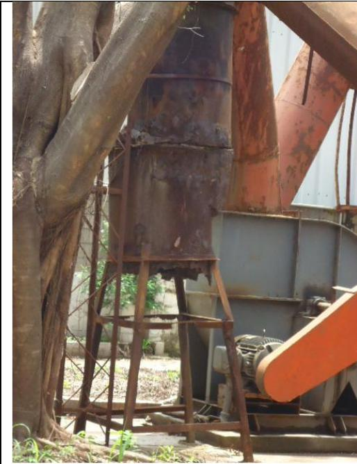
Foto 96. Chimenea cortada en su base y en diversos puntos a lo largo de la estructura.
