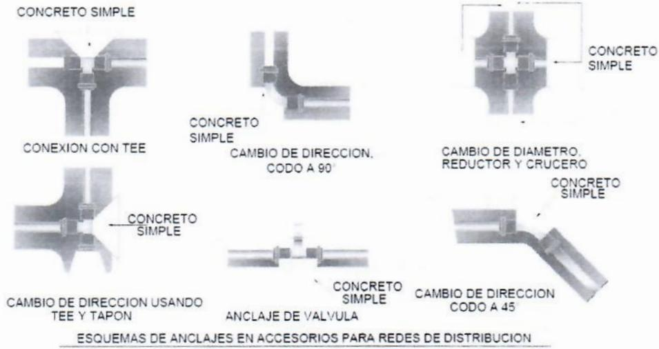
Detalle de anclajes en accesorios para redes de distribución de agua potable
