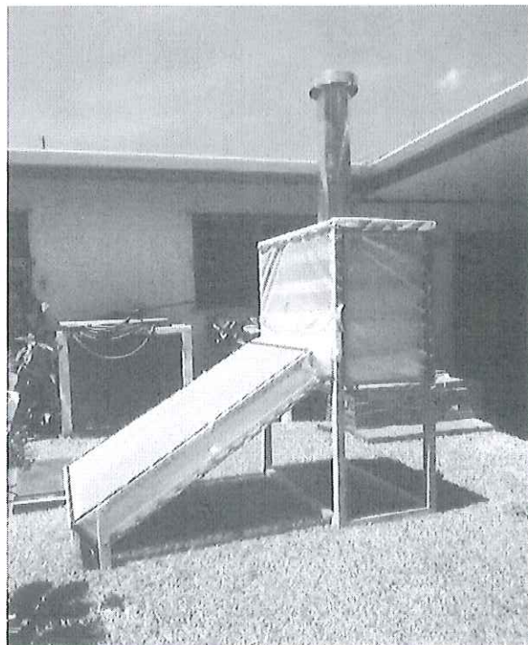
Ilustración 5 Deshidratadora de Madera con Chimenea
